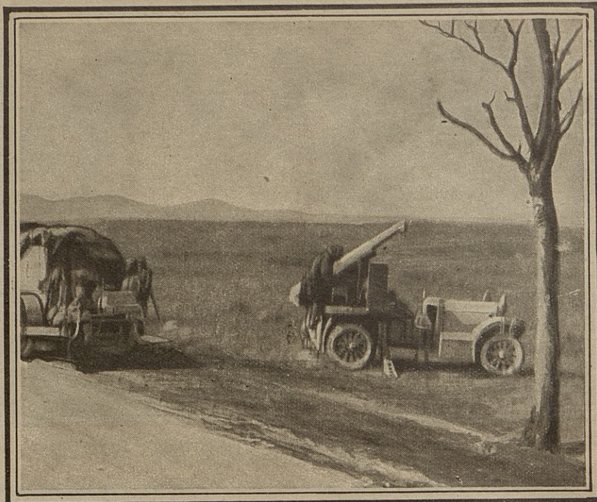
Le canon de 75, monté sur automobile, est amené par la route au point où il doit être mis en batterie ; le caisson qui porte les munitions est également automobile.
