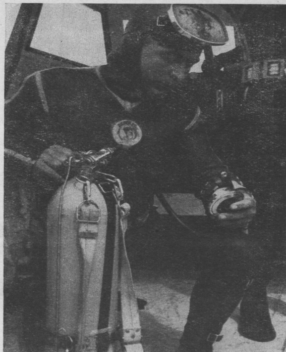
W butli tej znajduje się 2100 litrów powietrza sprężonego pod ciśnieniem 180 atmosfer. Pozwoli ono na oddychanie około 25 minut pod wodą
