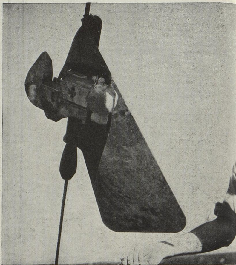
Attaché au brin de drague, la cisaille coupera le filin qui retient la mine au crapaud.
