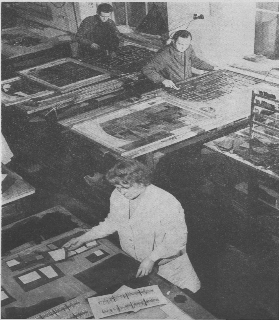
Wstawione w ramki z ołowiu szkiełka przygina się ręcznie. Ołów łatwo ustępuje pod naciskiem, nie kalecząc szkła. Równocześnie uszczelnia
