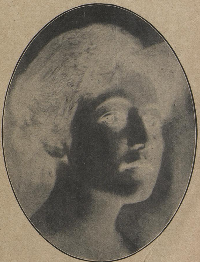
II. Von der vorliegenden Photographie wird ein Negativ durch Neuaufnahme hergestellt. Die hellen und dunkeln Stellen der Photographie werden dabei gleichzeitig mit Hilfe eines Rastes (des sog. Rasters) in ein System schwarzer und weißer Punkte zerlegt. (Unsere Abbildung zeigt, wie das Negativ auf Glas aussieht.)
