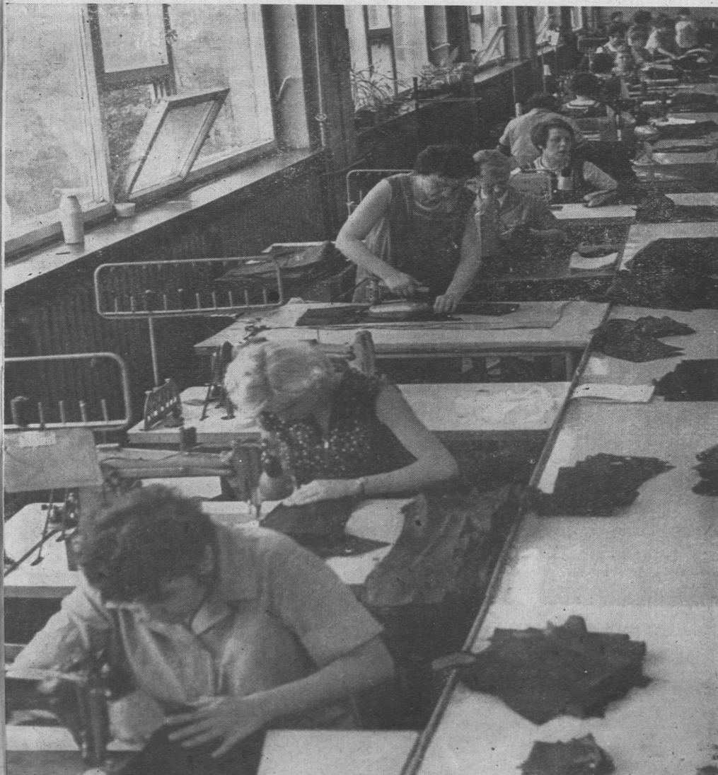
Na tej taśmie bieżącej produkowane są wyłącznie spodnie. Przy każdej maszynie krawcowa wykonuje tylko kilka dokładnie sprecyzowanych czynności
