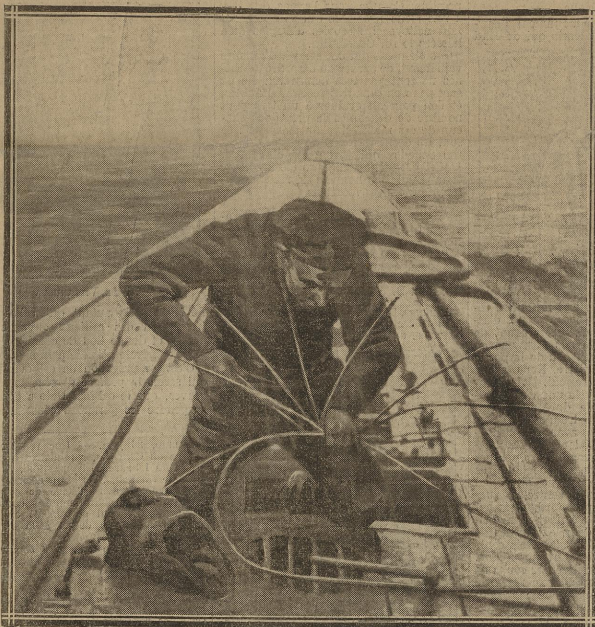
MATELOT FAISANT UNE ÉPISSURE A UN CABLE MÉTALLIQUE, AU LARGE
