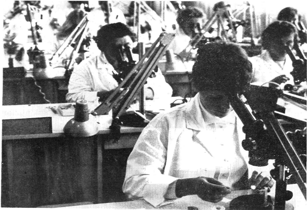
Montaż elementów odbywa się przy użyciu przemysłowych mikroskopów
