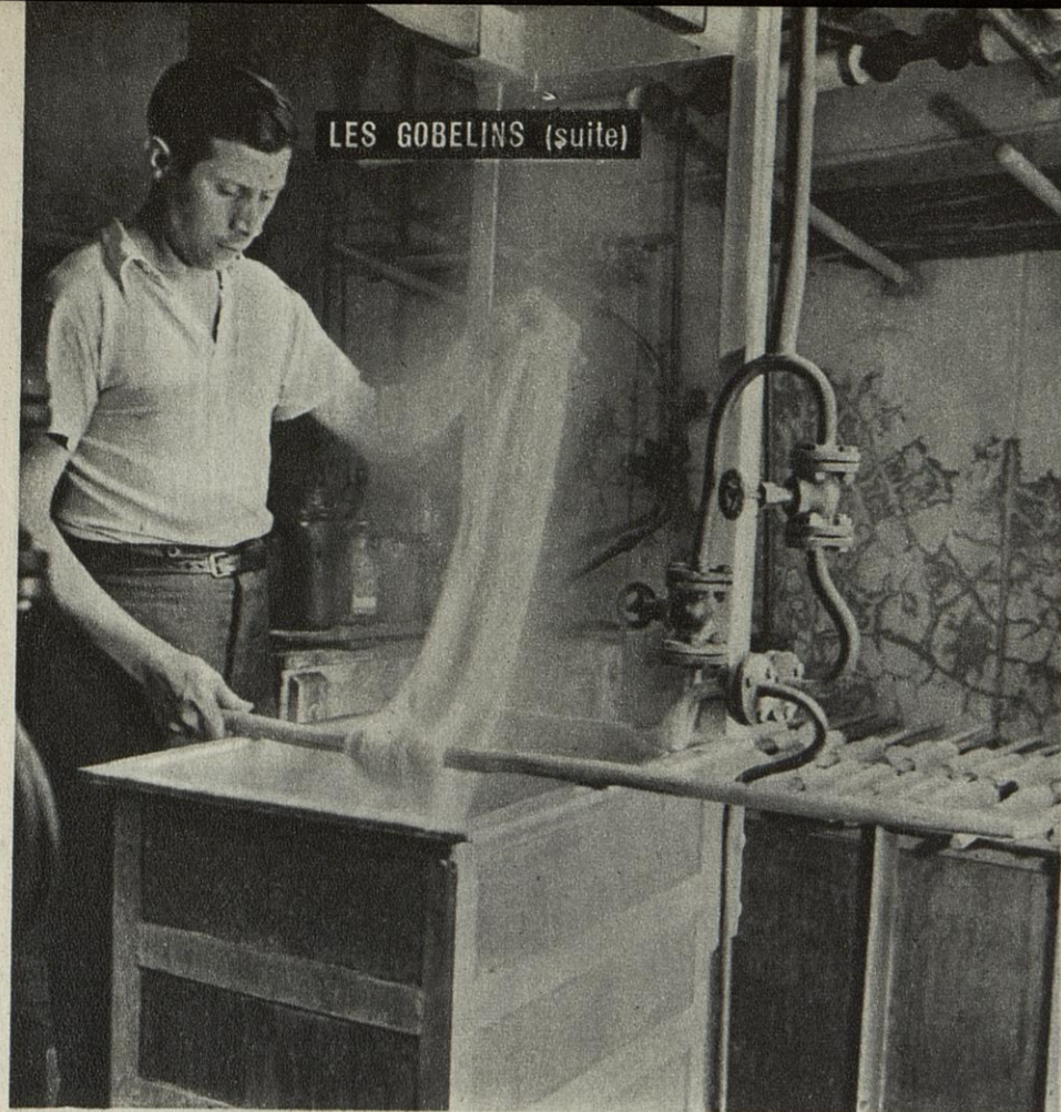
D'ABORD DEGRAISSES, LES ECHEVEAUX DE LAINE SONT PLONGES DANS DES BAINS DE TEINTURE. LES GRANDES LIGNES DU CARTON (AU FOND) SONT REPORTÉES SUR LES FILS DE LA « CHAÎNE ».
