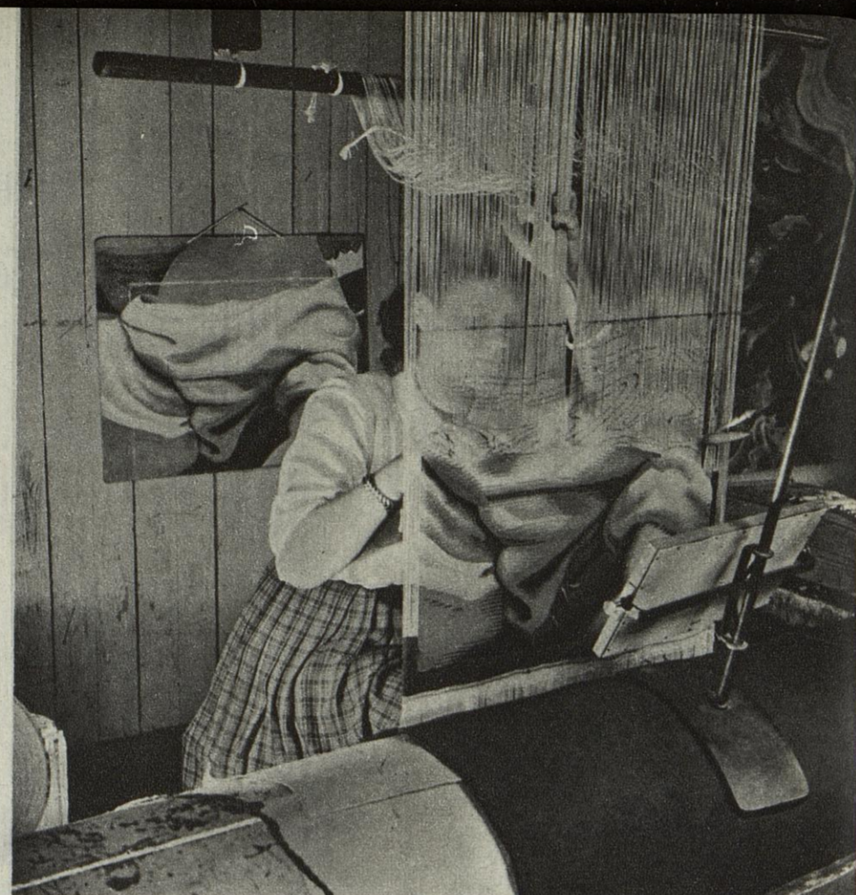
D'ABORD DEGRAISSES, LES ECHEVEAUX DE LAINE SONT PLONGES DANS DES BAINS DE TEINTURE. LES GRANDES LIGNES DU CARTON (AU FOND) SONT REPORTÉES SUR LES FILS DE LA « CHAÎNE ».
