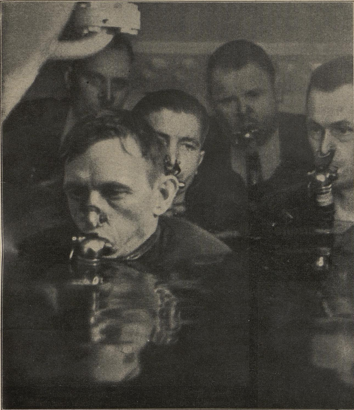
Das Wasser reicht bis zum Hals; jetzt bleibt es stehen. Die Mannschaft macht sich fertig zum „Aussteigen“. Der Druck der immer mehr zusammengedrückten Luft und die starken Luftfedern öffneten den Deckel völlig, und durch dieses LuK strömte so lange Wasser hinein, bis sein unterer Rand von allen Seiten umspült ist. Der Raum, in dem die Mannschaft auf den Ausstieg wartet, kann aber nicht bis zur Decke geflutet werden, da die zusammengebrückte Luft das Wasser nicht weiter steigen läßt. So können die Menschen für eine gewisse Zeit ohne Tauchretter noch atmen.
