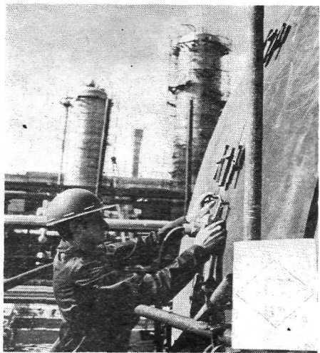
Prześwietlanie spawów zbiornika przy użyciu defektoskopu radioizotopowego Fot. Józef KICMAN
