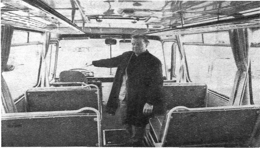
Wnętrze autobusu pokazuje inż. Jureczak. Duże szyby, cicha praca silnika, dobra amortyzacja. Wyprostować się może nawet mężczyzna o 190 cm wzrostu
