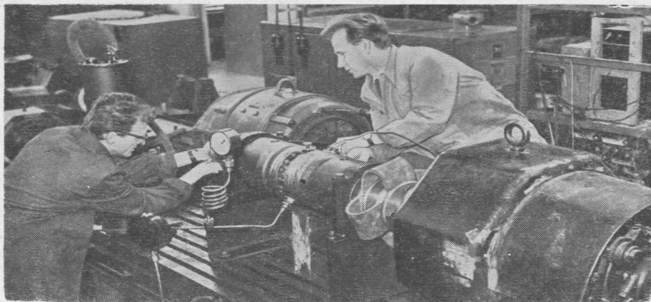
W Gliwickich Zakładach Konstrukcyjno-Mechanicznych Przemysłu Węglowego przy uniwersalnym stoisku przeznaczonym do badań hydraulicznych urządzeń stosowanych w maszynach górniczych przeprowadza się właśnie badania nowoczesnej wrębiarki ścianowej „EWA” (Elektryczna Wrębiarka Automatyczna)
