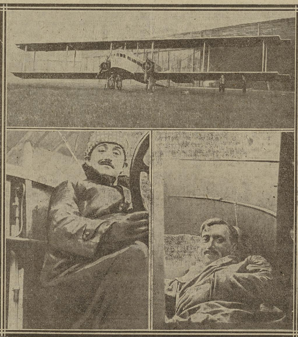
LE « GOLIATH » FARMAN ET SES DEUX PILOTES En haut : le biplan géant Farman, muni d'un moteur Salmson. — En bas : Bernard est au volant, pendant que Bossoutrot se repose dans une cabine spéciale, aménagée à l'avant de la carlingue.
