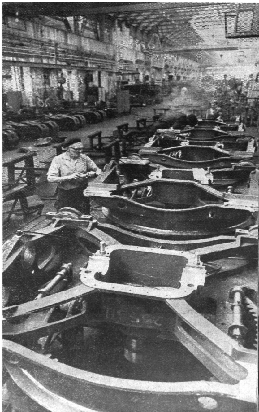
W tej hali na podwozia koparek zakłada się gąsienice
