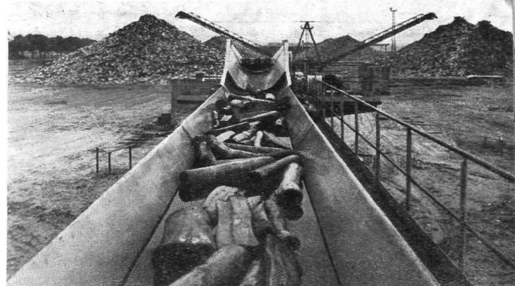
Taśmociąg łączy składy surowca z halami produkcyjnymi, bez końca przenosząc kłocki drewna
