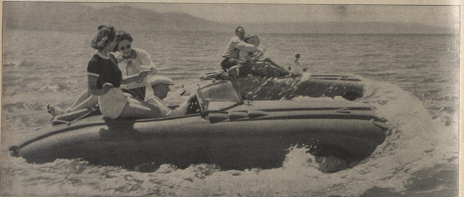
Acht Räder stehen still, zwei Schrauben wirbeln durch das Schwäbische Meer! Der Mann, der das rote Amphibium steuert, ist sein Schöpfer, Hans Trippel. Er steuert wie an Land, aber die Räder greifen nicht mehr. Nur die Borderräder wirken als Steuer. Die Bugwelle schäumt hoch auf, aber kein Tropfen Wasser dringt in die abgedichtete Maschine. Der stählerne Leib des Autos ist zum Bootkörper geworden. Mit 10 Knoten Geschwindigkeit geht es gegen Bregenz, das vom anderen Ufer des Bodensees grüßt.
