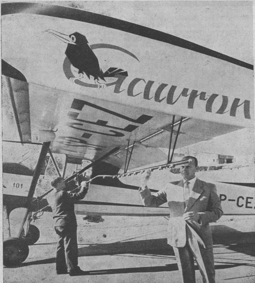
Pod skrzydłami „Gawrona” umocować można również przyrządy i urządzenia do opylania, opryskiwania lub rozsiewania preparatów chemicznych
