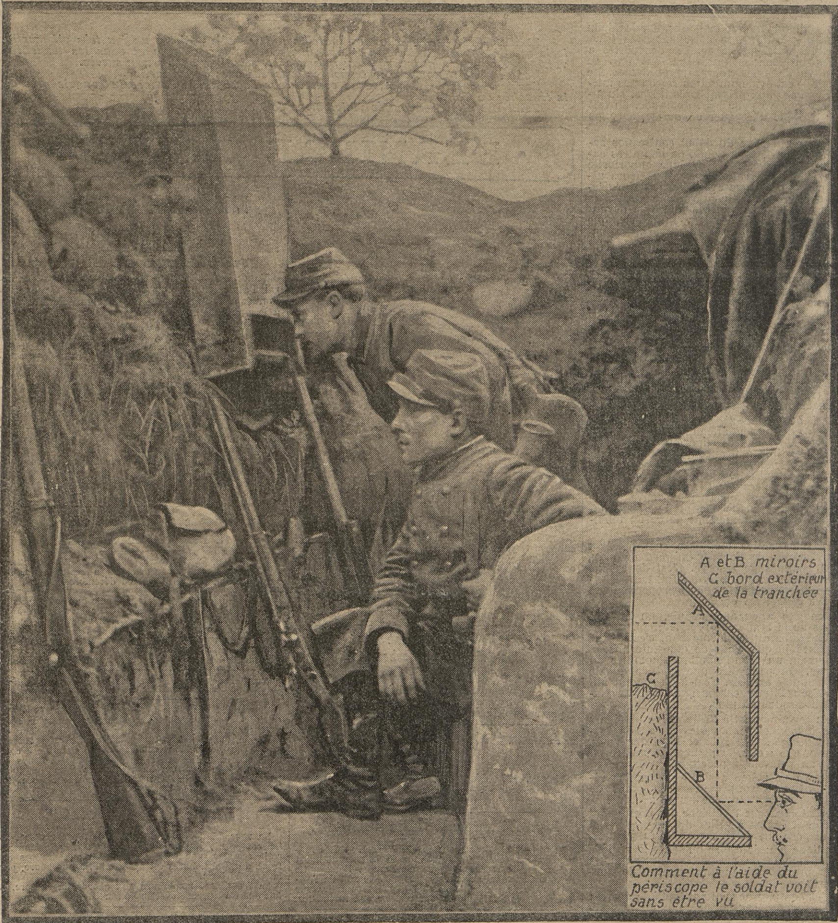
Grâce à ce périscopie, à peu près comparable à ceux utilisés à bord des sous-marins, nos fantassins postés dans les tranchées de première ligne peuvent découvrir le terrain qu'ils ont devant eux sans être atteints par les balles de l'ennemi. Le dessin que nous publions à côté de ce document montre la coupe schématique de l'appareil.
