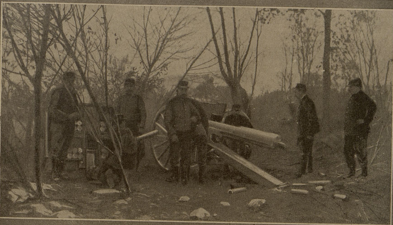
Le coup parti, la pièce a reculé sur son affût ; elle n'a pas encore été ramenée, par le frein récupérateur, dans sa position de tir. Les servants approvisionneurs s'apprêtent à passer la charge au premier servant de gauche.
