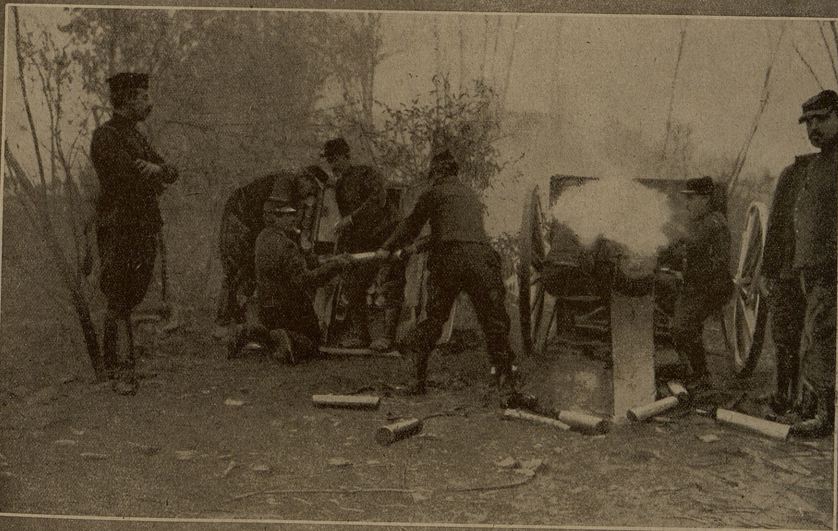
La pièce revenue automatiquement à la position de tir, le premier servant de droite ouvre la culasse, d'où s'échappe la fumée accumulée dans l'âme. La douille brûlée a été éjectée. Une douille nouvelle passe de mains en mains.
