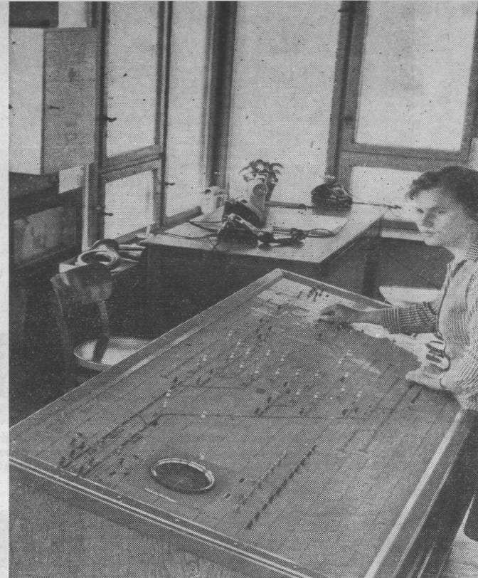
Praca w ogromnej hali przeróbki kamienia wapiennego jest zdalnie kierowana. Pracownicy obsługujący pulpit sterowniczy sprawdzają sytuację w hali na umieszczonym obok specjalnym odbiorniku telewizyjnym
