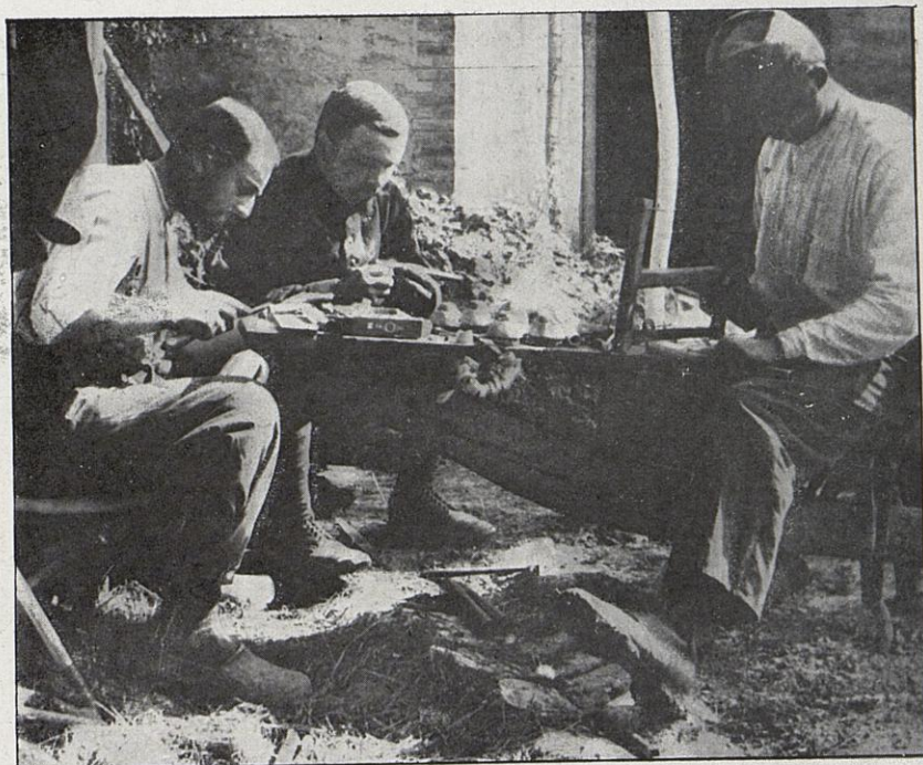
IV. — A l'aide d'une vulgaire scie de menuisier, nos joailliers débitent le lingot en rondelles. La bague peut passer maintenant dans les mains des ciseleurs. Remarquez l'établi, façonné avec les débris d'un affût.
