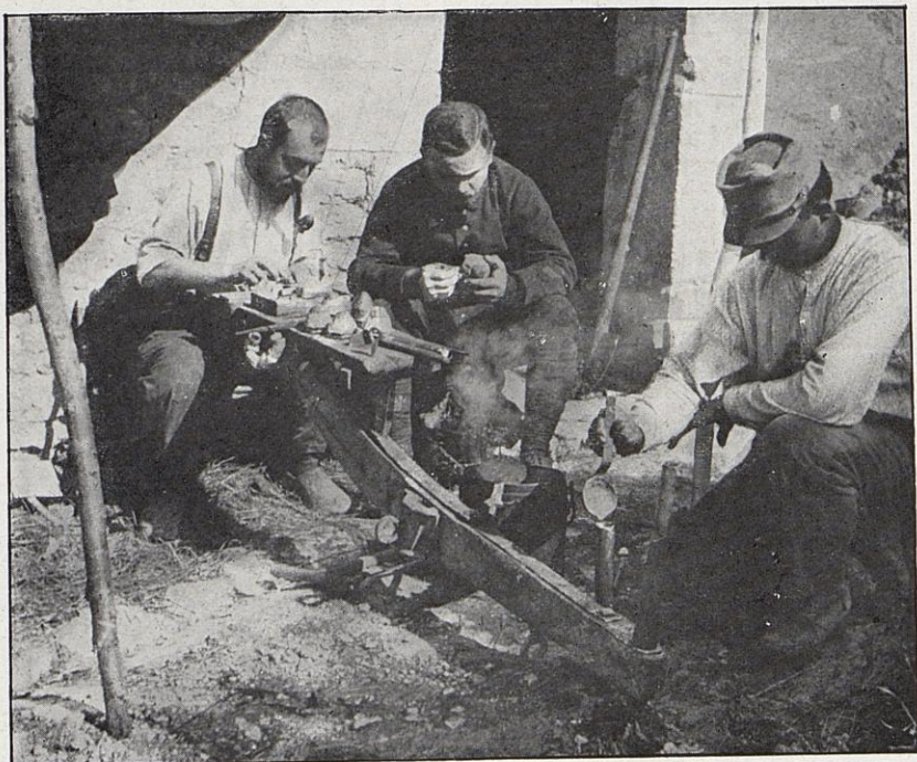
II. — L'aluminium fond à une température assez basse, soit environ à 650°. Quand le métal, chauffé dans une vulgaire marmite, est entré en fusion, nos ingénieux artisans le versent dans de vieux tubes de bicyclettes.
