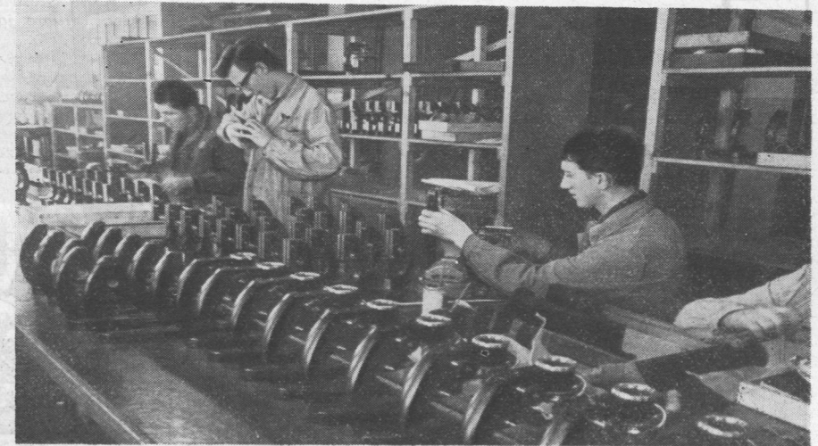
Nad produkcją magicznych szkiełek czuwają dziesiątki doskonałych specjalistów, którzy nadają polskim przyrządom optycznym nieskazitelną jakość i najwyższą wartość użytkową. Na zdjęciu poniżej: czynność nazwana bardzo romantycznie „docieraniem jaskółczych ogonów” czyli prowadzić do najpowszechniej używanych dla różnych celów mikroskopów konwencjonalnych
