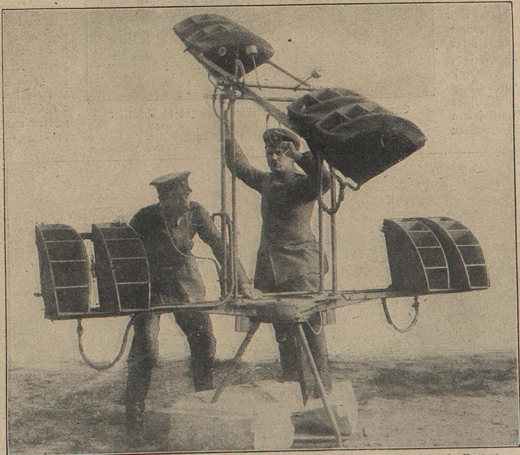
In Italien erbeuteter Flughör-Apparat französischer Konstruktion, der Abwehr-Batterien zur Feststellung von Fliegern dient. Phot. Bild- u. Film-Amt.
