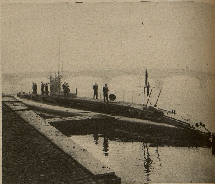
Le sous-marin « Montgolfier », qui est amarré au pont de la Concorde, est un submersible Laubeuf; il déplace 398 tonnes; sa longueur est de 51 m. 12 et sa largeur de 4 m. 97. Il fait 12 nœuds en surface.
