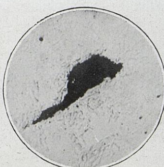
Soufflures dans l'acier.
