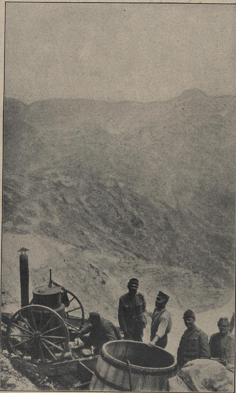
Fahrbare Schneeschmelz-Kessel bei den österreichisch-ungarischen Truppen auf dem Arn. Phot. Alice Schalek.
