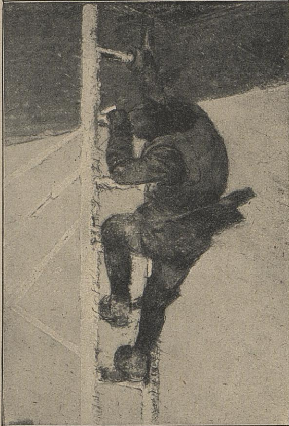
Ein schwieriger Kletterweg während der Fahrt: Ein Mann der Besatzung des Luftschiffes auf der Leiter, die von der Gondel in den Schiffskörper führt und in großen Höhen oft vereist ist.
