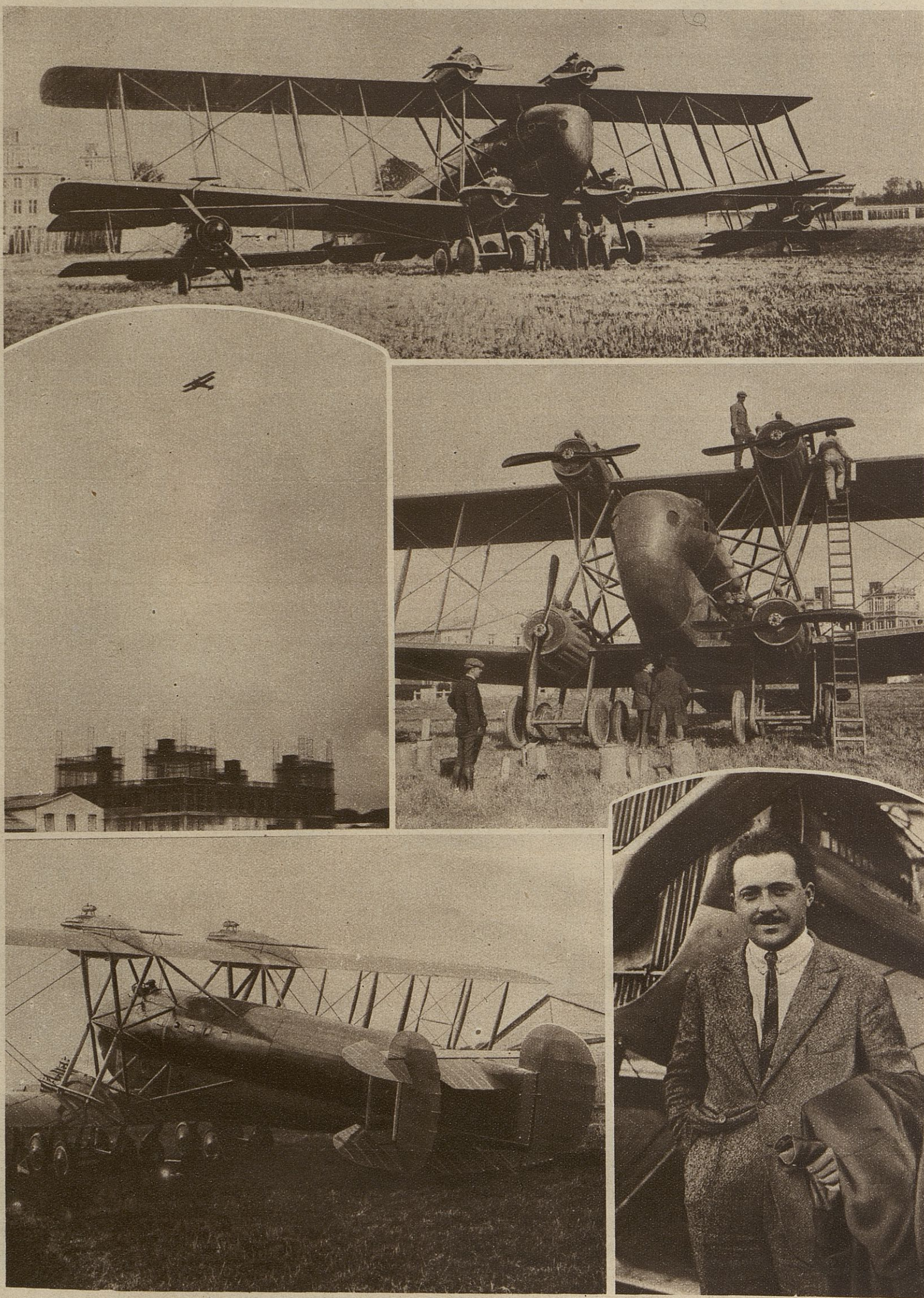
L'aviateur Sadi Lecointe, dont voici la photographie, a essayé le 2 octobre, à Buc, ce nouvel aérobus, construit par Blériot, et dont les quatre moteurs ont ensemble le force de 1.000 HP. Il peut porter 28 passagers. On voit, en haut de la page, au pied de ce géant, ces deux pygmées que sont les glorieux avions de chasse de Fonck et de Nungesser. Au-dessous, ce sont : l'aérobus en son premier vol, ses quatre moteurs et son immense nacelle.
