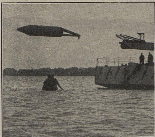
Ein Bild, daß das Geheimnis des Geschosses verrät: Pfeilgerade wie ein Flugzeug... muß das Geschöß katapultiert werden, denn es ist der Ballastkörper, an dem die Schleuderschützen lernen, wie man ein Flugzeug richtig katapultiert.
