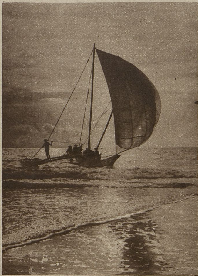
Les indigènes de Ceylan empêchent leurs bateaux de chavirer en les munissant de ce balancier, qui se compose de deux longues et fortes antennes, à l'extrémité desquelles est liée transversalement une lourde pièce de bois.
