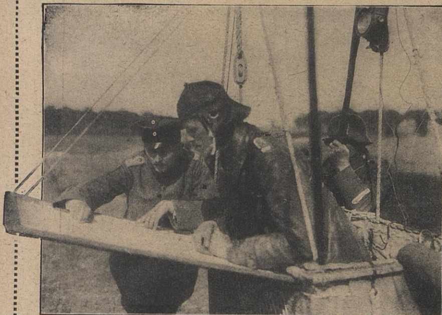
Bei unseren Feldluftschiffern: Besprechung mit dem Ballonbeobachter vor dem Aufstieg. Am Ballontorb ist die Karte des Geländeabschnittes angebracht. Mannschaftsappell mit Vorzeigen der Fingernägel, die vorschriftsmäßig geschnitten sein müssen, damit die Ballonhülle nicht verletzt wird.
