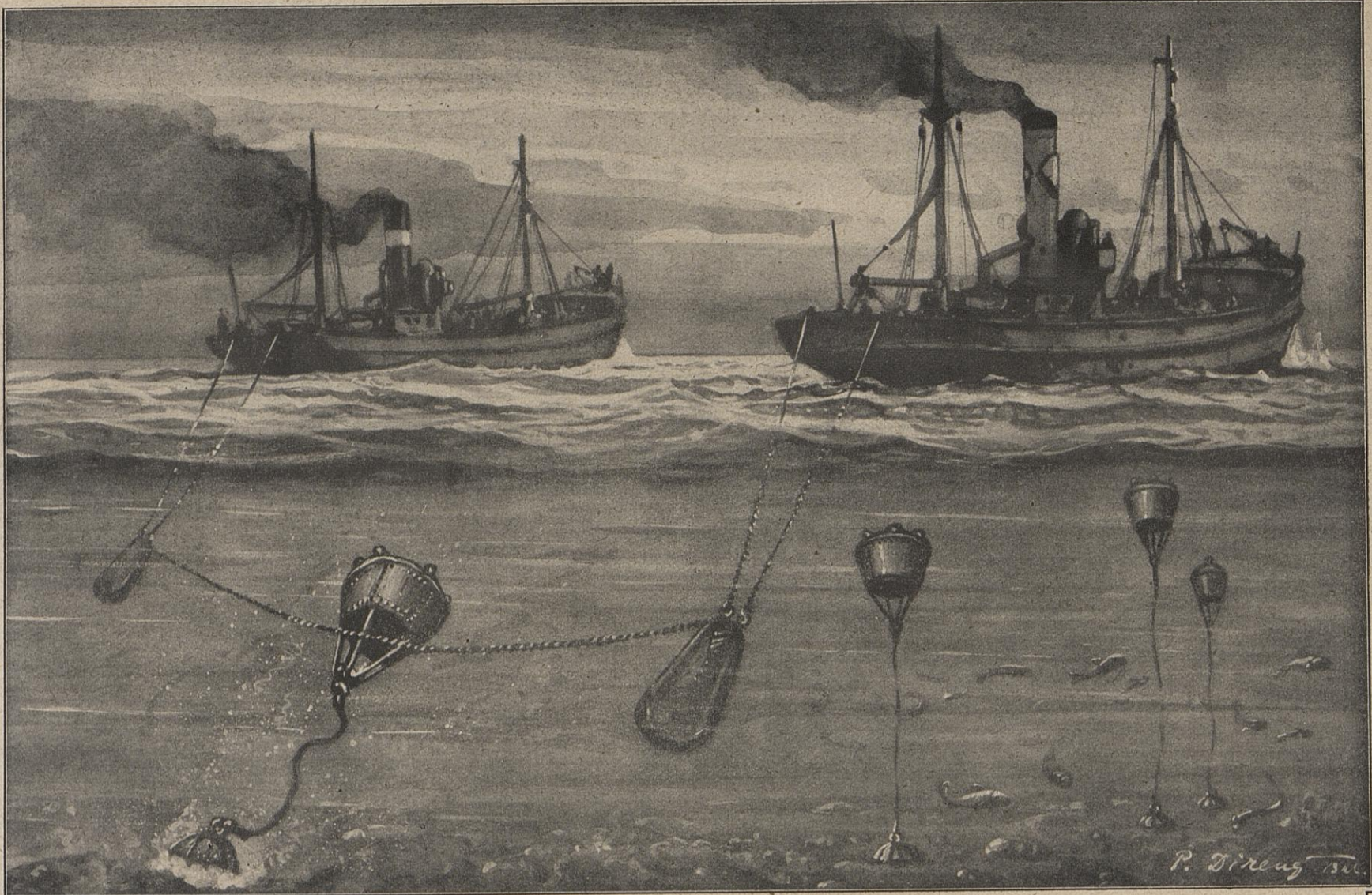
Ein wirksames, aber gefährliches Mittel gegen Seeminen: Auffischen der Minen. Dampfer mit geringem Tiefgang schleppen beschwerte Drahttaue hinter sich her, die die Minen aus ihrer Verankerung reißen.
