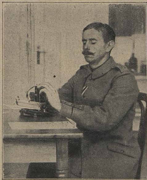
Ein Blinder an der Schreibmaschine, deren Tasten erhabene Buchstaben tragen, die durch Abfühlen gelesen werden.
