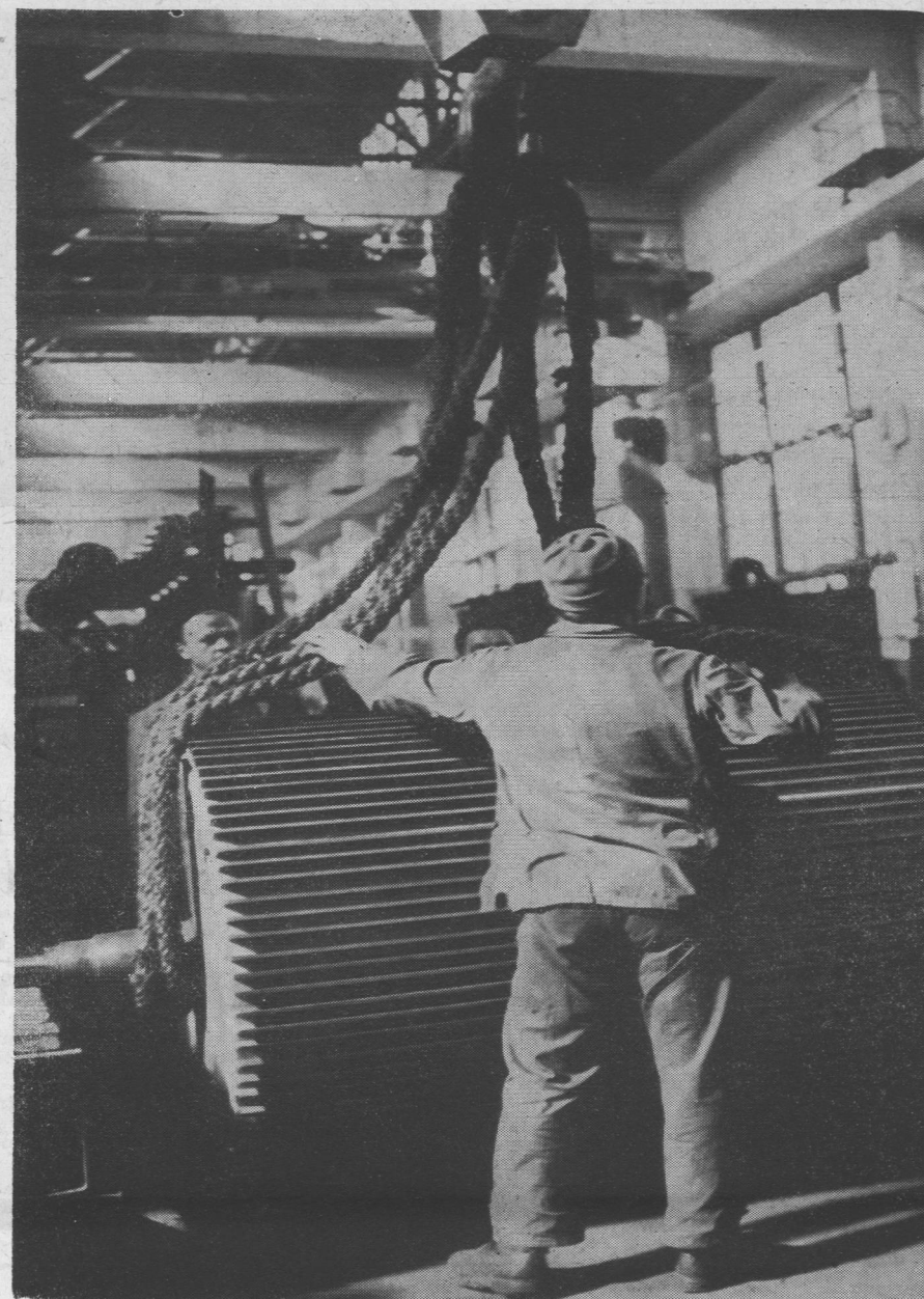
To „kółko zębate” (powyżej) należy raczej do drobiazgów w maszynie zwanej kartoniarką. Waży przecież „tylko” 7 ton, gdy walec główny ma ciężar dziesięciokrotnie większy i nie jest jedynym wykraczającym wagą ponad inne elementy. Zgrupowane detale maszyny papierniczej czynią wrażenie wielkiego bałaganu, ale wytrawni fachowcy „FAMPY” potrafią bezbłędnie złożyć z 50 tysięcy elementów zespół, w którym wszystko działa bez zastrzeżeń
