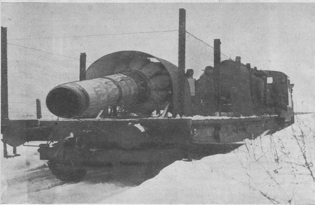
Rewelacyjny, choć prosty polski wynalazek na biały żywioł: odrzutowy silnik samolotowy na wagonie kolejowym. Po zapuszczeniu rozprasza największe nawet śnieżne zasy, których nie pokonałyby najpotężniejsze pługi śnieżne
