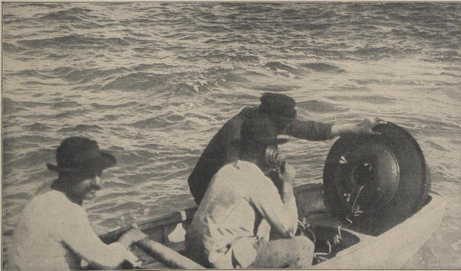
Verständigung mit einem untergetauchten U-Boot mit Hilfe einer vom U-Boot emporgelassenen Telephonboje. Aus dem „Motor“, Verlag Gustav Braunbeck.
