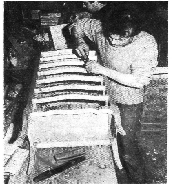
Zbyt grubą warstwę dykty zrywa się, po czym wszystkim częściom nadaje się właściwy profil
