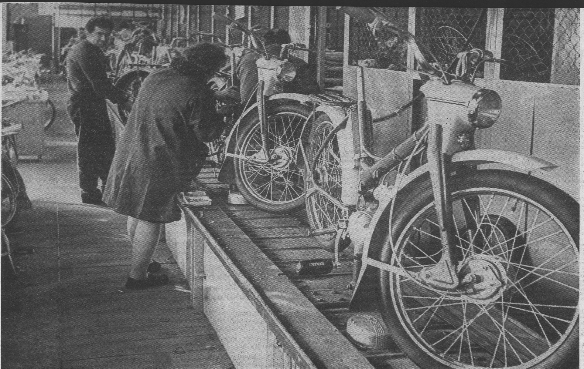
„Komary” na taśmie montażowej. Za chwilę będą już gotowe. Wyposażenie prawie motocyklowe, a zużycie paliwa liczy się jak na naparstki
