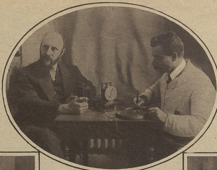
LA MESURE DE LA SENSATION AUDITIVE PAR LE CHRONOMETRE DE D'ARSONVAL. LE SUJET (à gauche) PRESSE UN BOUTON DÈS QU'IL ENTEND LE SON PRODUIT PAR L'APPAREIL DE L'EXPERIMENTATEUR (à droite).
