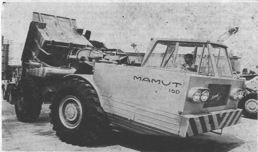
Wśród maszyn i urządzeń budowlanych i drogowych oferowano „Mamuta” z silnikiem o mocy 160 KM, produkcji Zakładów Metalowych we Wrocławiu
