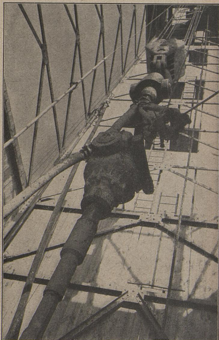
Ein Flaschenzug zieht den Kopf des Bohrgestänges hoch. Durch das Kopfstück (in der Mitte des Bildes) wird der zur Bohrung notwendige Wasserstrahl dem erdöhlhaltigen Boden zugeführt. An ihm ist das kilometerlange Bohrgestänge festgeschraubt, das mehrere hundert Tonnen wiegt.
