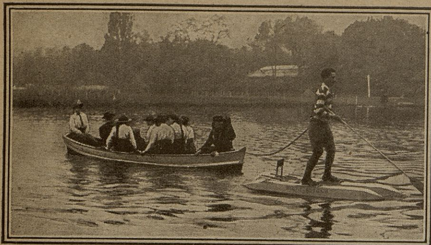
On a expérimenté au bois de Boulogne un « hydro-sky », appareil destiné à la marche sur l'eau. Il se compose de deux flotteurs en toile imperméable reliés à l'arrière par un axe sur lequel est montée une roue à quatre aubes, qui fait glisser l'appareil en avant.
