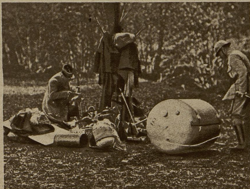
La nacelle principale, disposée à l'avant, dans l'axe du moteur, et contenant le poste de commandement. Au-dessous, près des objets retirés de la nacelle, on voit un réservoir d'essence.
