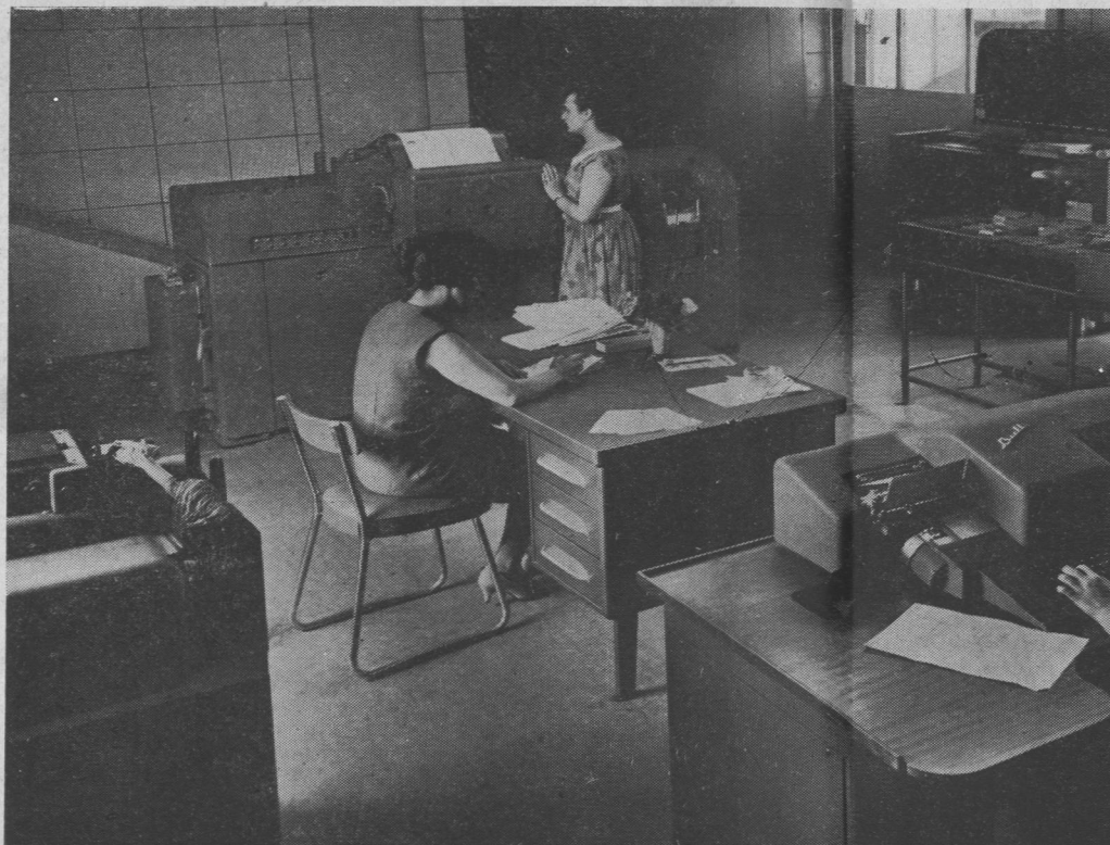
Zespół maszyny „Bull”. Na pierwszym planie dziurkarka kart, w głębi tabulator wykonujący
