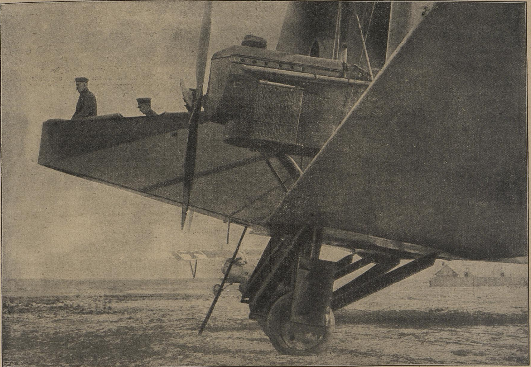
Die Flugzeuge unserer Feinde: Teilansicht eines erbeuteten englischen Handley-Page-Riesenflugzeuges mit dem Rumpfvorderteil, in dem Plätze für den Führer und einen Maschinengewehrschützen vorgesehen sind.
