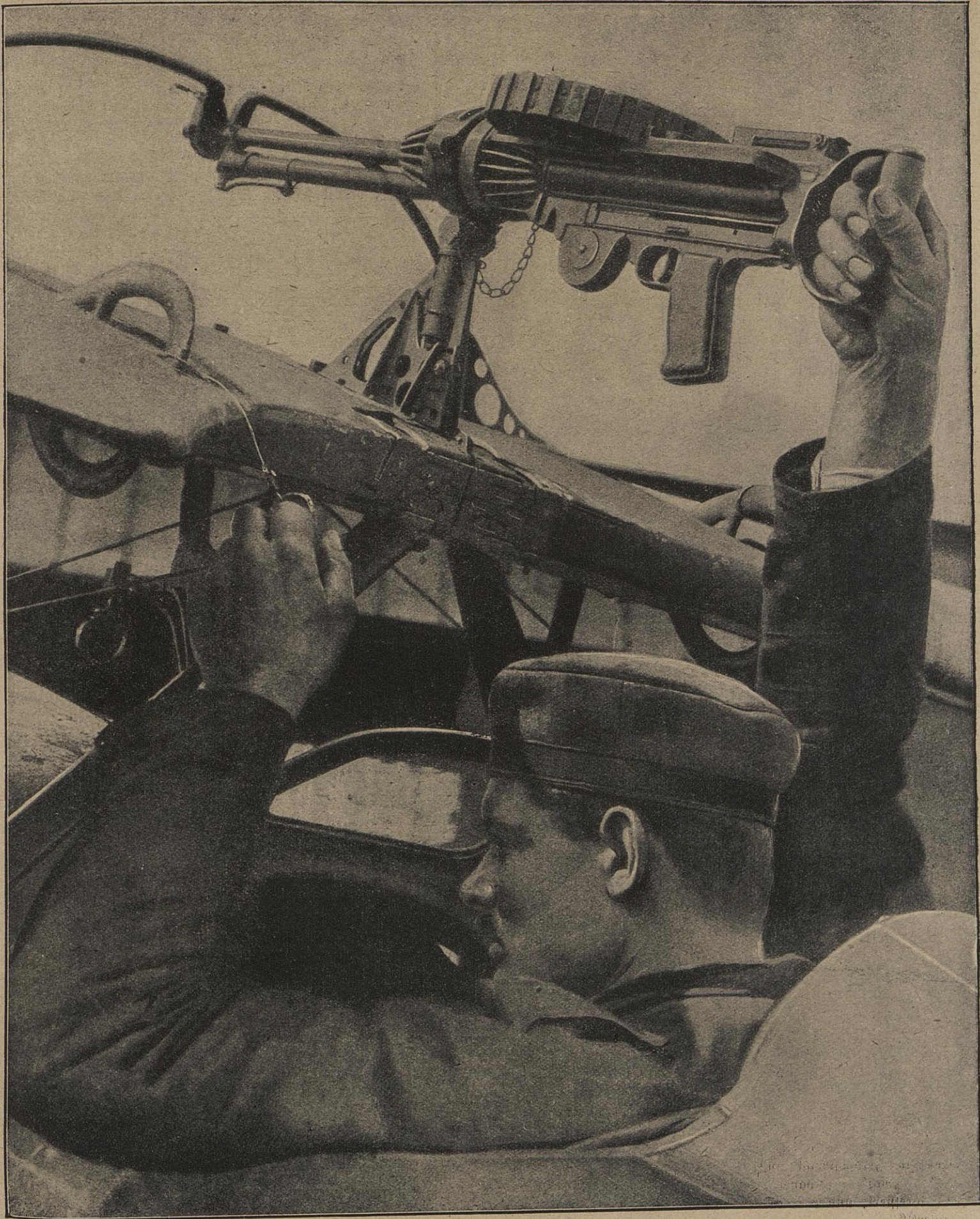
Erbeuteter französischer Nieuport-Kampfeinsitzer mit einem Maschinengewehr, das an der oberen Tragfläche angebracht ist. (Zu dem Artikel „Die Luftwaffe unserer Feinde“, Seite 68.)
