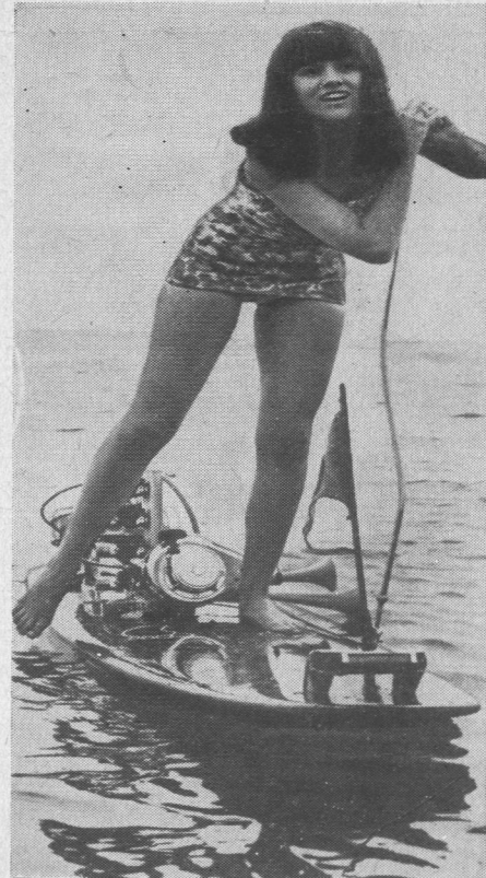
Nowym osiągnięciem w sportach wodnych jest wyposażona w 20-konny silnik „deska” do jazdy na wodzie z szybkością ok. 20 km/godz.
