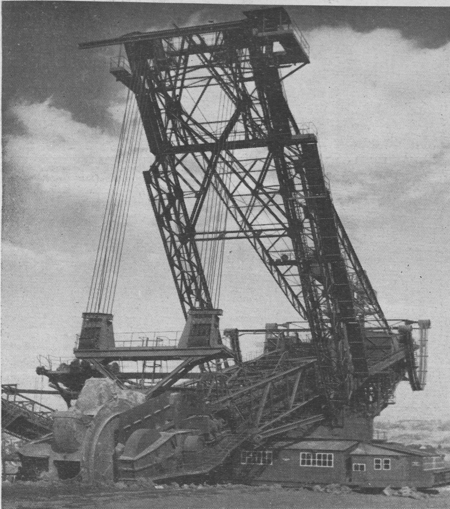
Na Dolnym Śląsku, w Zagłębiu Turowskim, trwają intensywne prace nad przygotowaniem do eksploatacji olbrzymiej kopalni odkrywkowej węgla brunatnego. Złoża węgla brunatnego, odkryte niedawno w tych okolicach, dostarczać będą paliwa do wielkiej elektrowni na węgiel brunatny. Na zdjęciu olbrzymia koparka, której zadaniem jest usunąć mechanicznie sponad pokładu węgla miliony ton „nadkładu” ziemnego.
