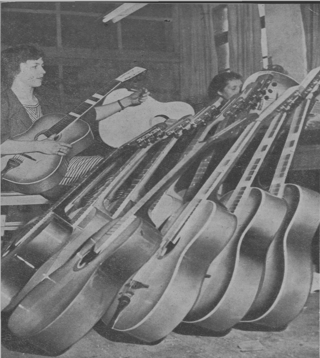
„Kombinat muzyczny” produkuje rocznie ponad 50.000 instrumentów. Mimo masowej produkcji lubińskie instrumenty znane są z doskonałej jakości i świętego brzmienia tonu. Zanim trafią do odbiorców, poddawane są surowym oględzinom specjalistów. Na zdjęciu kontrola gitar orkiestrowych
