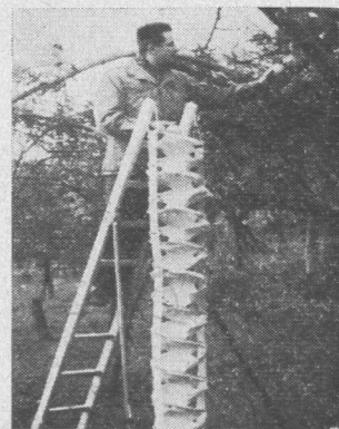
Ten prosty w konstrukcji przyrząd składa się z połączonych ze sobą systemem schodkowym naczyń z miękkiej tkaniny, przez które nieobtluczony owoc spada wprost do podstawionej na dole skrzynki
